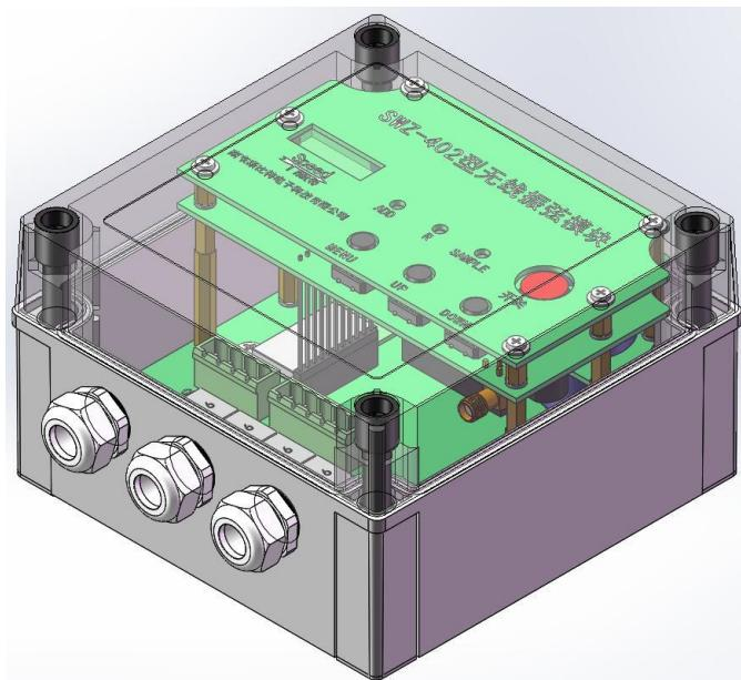
图一 SWZ-402 无线振弦模块结构图
